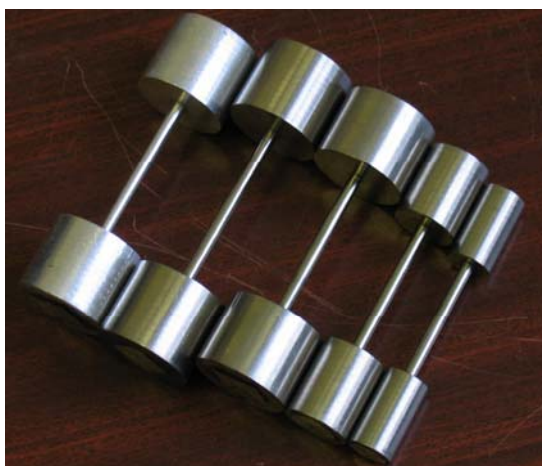
Рисунок П.2.3. Гантельные образцы.
