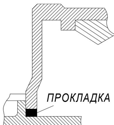
Рис. 27. Применение упругих прокладок при установке деталей по двум параллельным плоскостям
