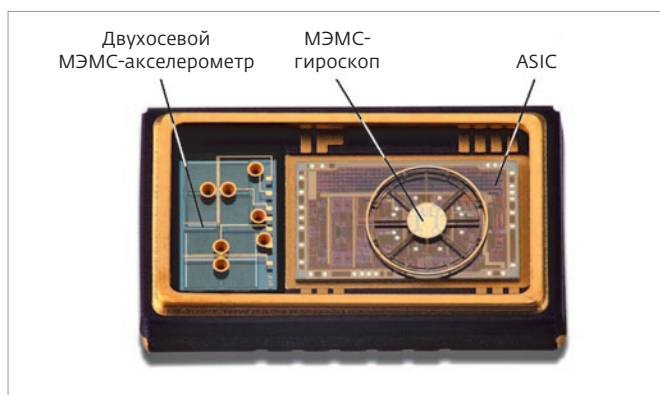
Рис.1. Расположение датчиков в гибридной сборке CMS300
