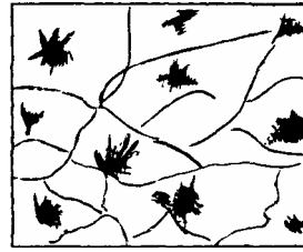
Рис.3.6. Структуры высокопрочного (а) и ковкого (б) чугунов с ферритной металлической основой
