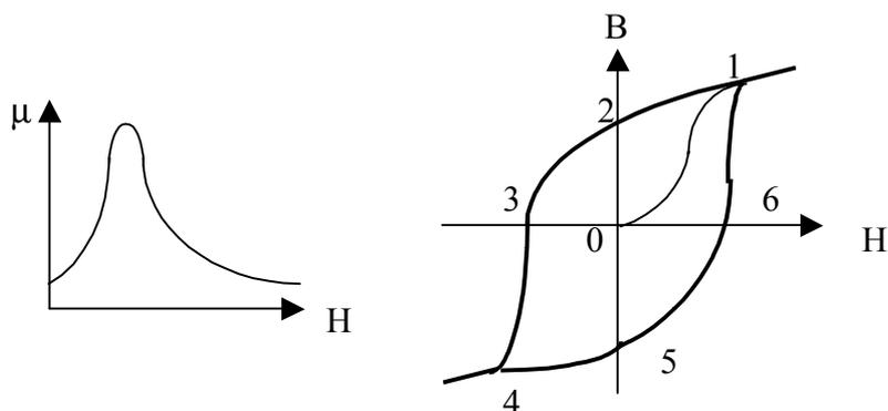
первоначально ненамагниченный ферромагнетик намагничивать, то зависимость  $B$  от  $H$  идет по основной кривой намагничивания. Но если после достижения насыщения (линейная зависимость  $B$  от  $H$ ) уменьшать  $H$ , то кривая пойдет выше (линия 1–2), а затем пройдет точки 2–3–4. Если же теперь проделать все дальше, то кривая пройдет через точки 4–5–6
