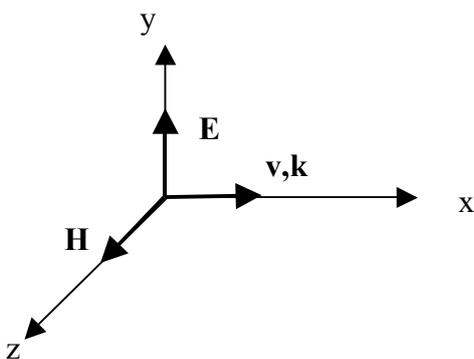
2) Вектора электрического и магнитного поля взаимно перпендикулярны:  $\vec{H} \perp \vec{E}$ . Это условие так же сразу следует из формулы  $k \times \vec{E} = \omega \mu_0 \vec{H}$ . Теперь можно утверждать, что вектора  $\vec{k}, \vec{E}, \vec{H}$  составляют правую тройку векторов, что и показано на рисунке. Напоминаем, что рассматривается плоская электромагнитная волна. Однако на рисунке она еще и плоско поляризована (свойство 5).
