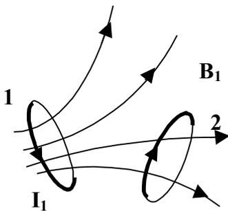
Если в контуре 1 течет ток  $I_1$ , то он создает магнитное поле, которое пронизывает контур 2. В контуре 2 магнитный поток, связанный с током  $I_1$ , равен  $\Phi_2$ . Естественно, что  $\Phi_2$  будет пропорционален току  $I_1$  (при отсутствии ферромагнетиков). Коэффициент пропорциональности обозначим через  $L_{21}$ . Для этого случая связь между потоком и током будет такова:
