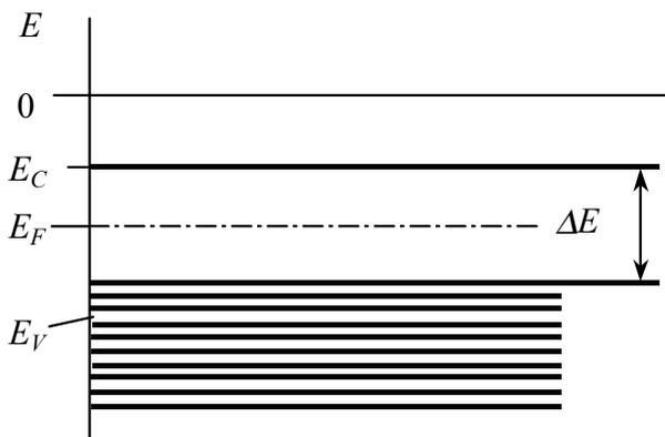
дырки, то их концентрация равна  $n_h = \left[ \frac{1}{3\pi^2} \frac{2m_h}{\hbar^2} \right]^{3/2} (E_V - E_F)^{3/2}$ : где  $m_h$  эффективная масса дырки валентной зоне [2, 3];  $\hbar$  - постоянная Планка, деленная на  $2\pi$ .
