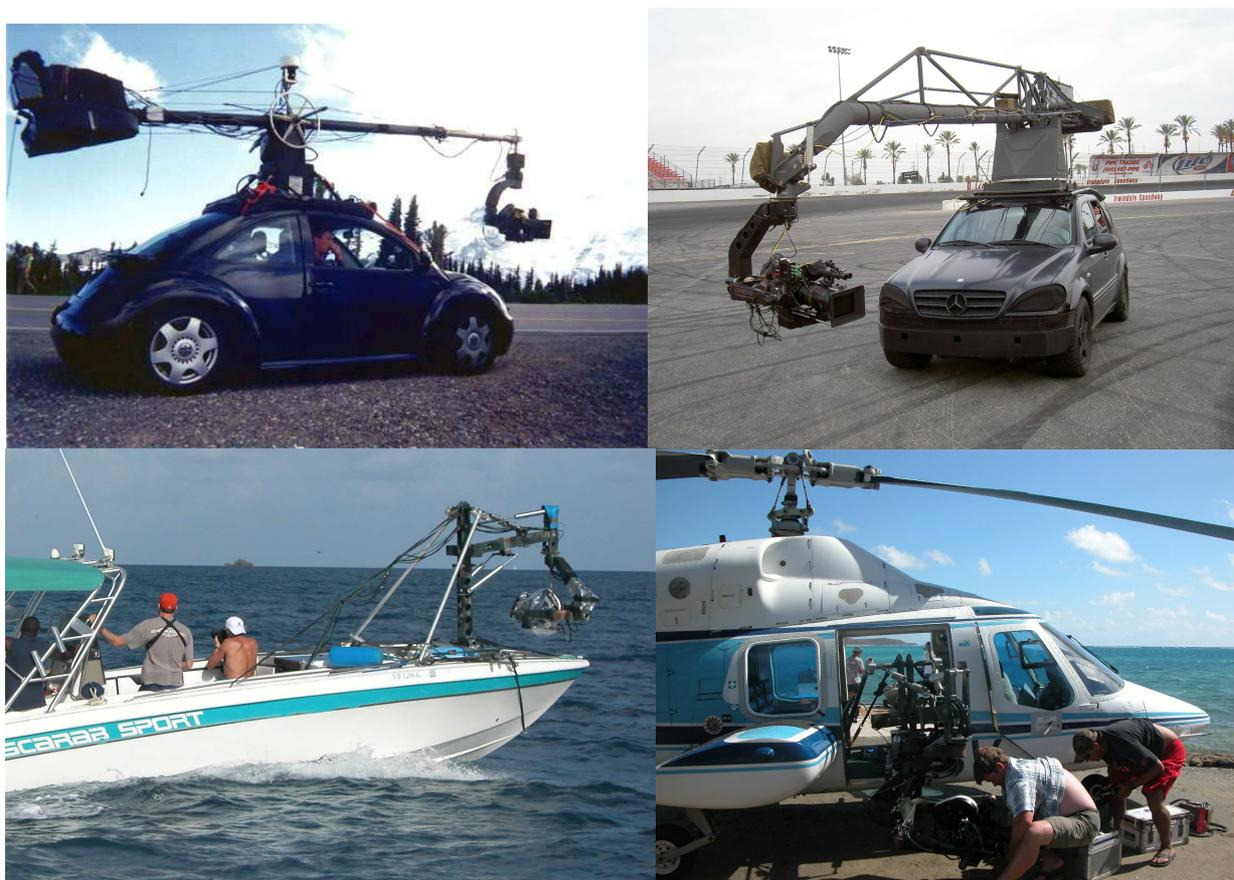
Рис. 6. Гиростабилизаторы типа 4ГСП на операторском кране, катере, автомобиле, вертолете.
