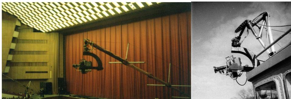
Рис. 5. Гиростабилизатор 4ГСП на операторском кране и катере.
