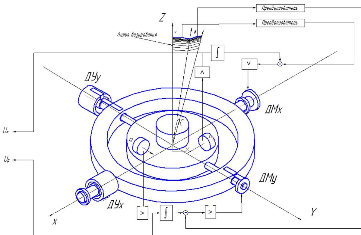
ГС состоит из платформы, с закрепленными на ней КЦ и двумя ВОГ, которая помещена в двухосный наружный карданов подвес, а также системы стабилизации и устройств вывода информации потребителям.
