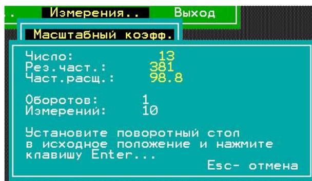
4) Включите вращение поворотного стола в направлении против часовой стрелки со скоростью ~ 50 град./с. Скорость вращения определяют по времени одного оборота стола. Скорости вращения стола 50 град./с соответствует время одного оборота стола 7,2 с.
