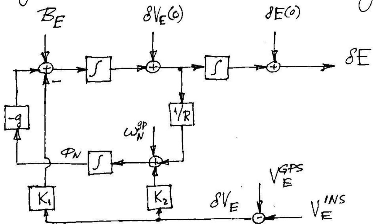
Для демодуляции или разность показаний ИНС и GPS по скорости. Возведенная ошибка ИНС по скорости  $\delta V_E$  подается на вход 1-го интегратора  $\frac{d}{dt}$  коэф.  $K_1$  и на "датчики моделига", "матформац" (квадр-ник дм)  $\frac{d^2}{dt^2}$  коэф.  $K_2$
