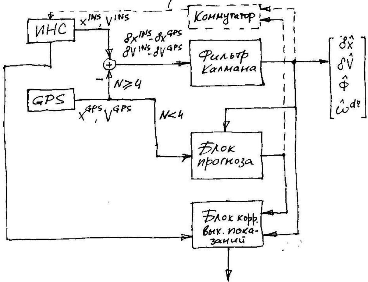
Здесь разности показаний ИНС и GPS по координатам и скоростям поступают в фильтр Калмана в качестве измерений. При этом ошибки ИНС выражаются в виде непосредственно измеренных компонент вектора состояния, а ошибки GPS-измерений — нуля. В фильтре в качестве модели исп. суп-л. ошибок ИНС, так что фильтр оценит
