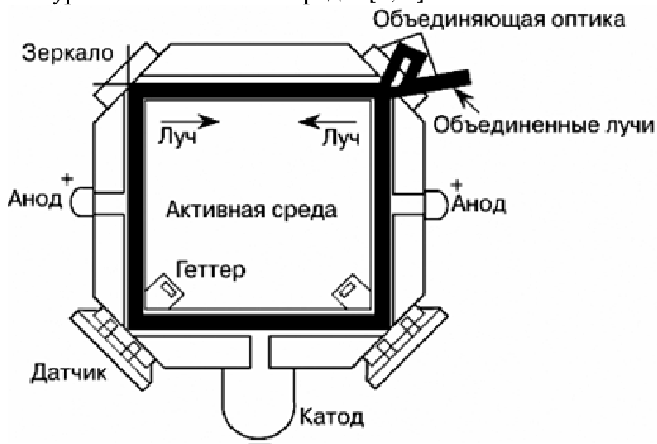
Рис. 1.2. Конструкция кольцевого лазерного гироскопа
