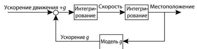
Рис. 4. Определение местоположения с использованием акселерометра
