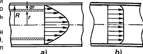
Скорость частиц быстро возрастает по мере удаления от поверхности трубы, затем изменяется довольно незначительно, вследствие интенсивного перемешивания (рис. (в)).
