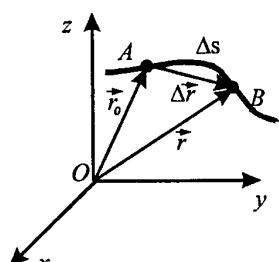
В **прямоугольной декартовой системе** координат каждый вектор  $\vec{a}$  можно однозначно представить в виде  $\vec{a} = a_x \vec{i} + a_y \vec{j} + a_z \vec{k}$ , где  $\vec{i}, \vec{j}, \vec{k}$  — единичные векторы (**орты**) по осям координат  $x, y, z$ . Числа  $a_x, a_y, a_z$  называются **прямоугольными декартовыми координатами** вектора  $\vec{a}$ .
