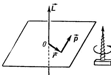
**Моментом импульса относительно неподвижной оси  $z$**  называется скалярная величина  $L_z$ , равная проекции на эту ось вектора момента импульса, определенного относительно произвольной точки  $O$  данной оси. Значение момента импульса  $L_z$  не зависит от положения точки  $O$  на оси  $z$ .
