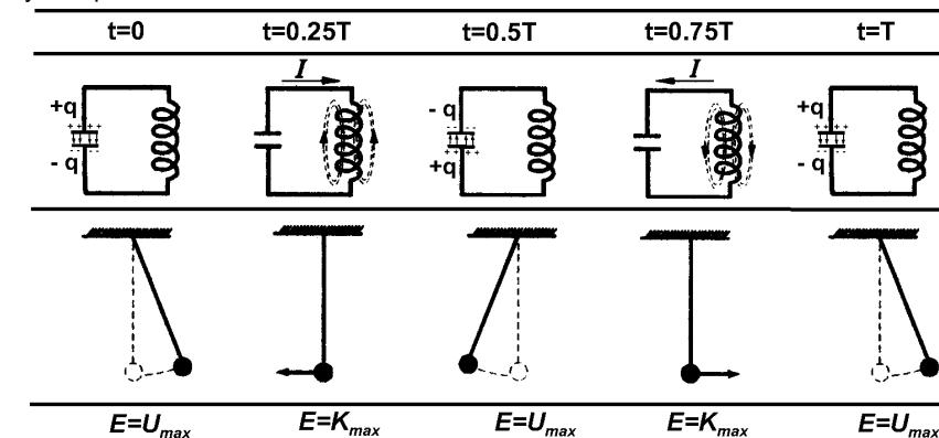
Пусть в начальный момент времени  $t = 0$  конденсатор заряжен зарядом  $q$ . Тогда энергия электрического поля между обкладками конденсатора  $W_e = \frac{q^2}{2C}$ . При замыкании конденсатора на катушку индуктивности, в контуре потечет возрастающий ток  $I$ . Энергия электрического поля начнет уменьшаться, а энергия магнитного поля катушки  $W_m = \frac{LI^2}{2} = \frac{L\dot{q}^2}{2}$  будет возрастать. Поскольку потерь в контуре нет ( $R = 0$ ), то полная энергия
