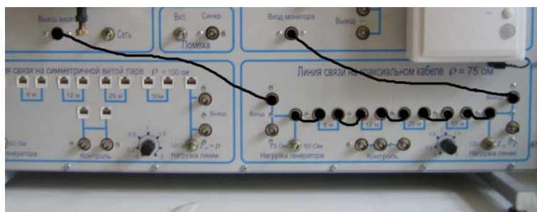
Рисунок 4.3 – Подключение коаксиальной линии
